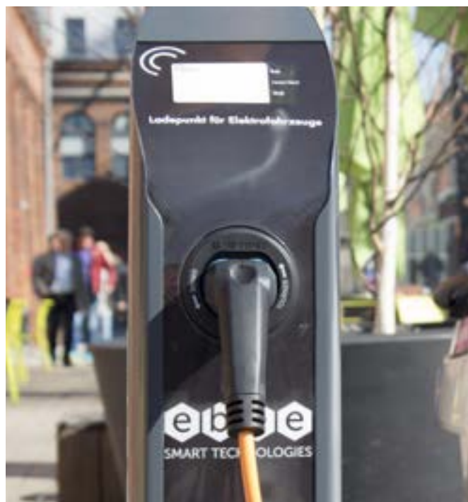
Ladepunkt von Ebee: Die Nutzeridentifikation und Authentifizierung erfolgt über RFID oder die App.
