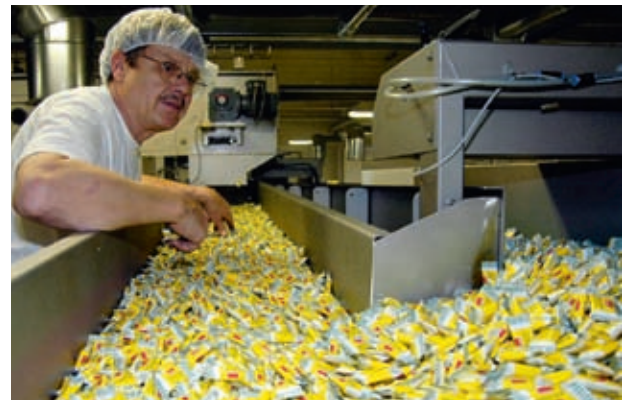
Mitarbeiter bei der Sichtkontrolle der verpackten Bonbon-Flowpacks, Katjes Fassin GmbH + Co. KG in Potsdam
